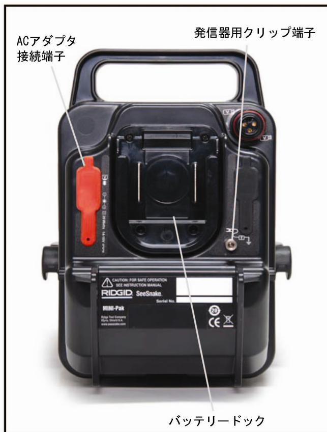
図 7 AC アダプタ接続端子、発信器用クリップ端子、バッテリードック
