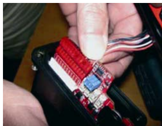
図 26 プラグコネクタの挿入
