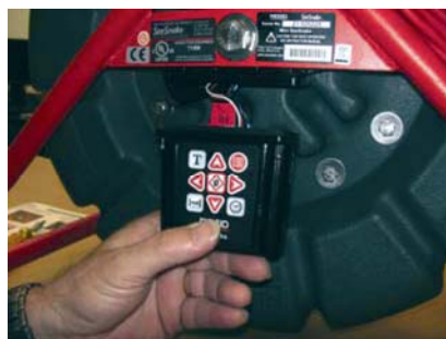
図 28 取り付け直前のカウントプラス
