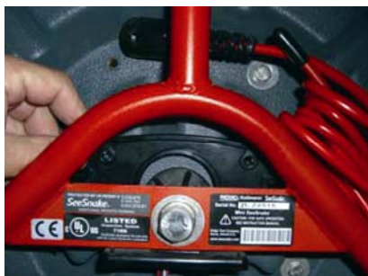
図 21 プレートの取り付け
