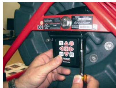
図 29 カウントプラスの取り付け
