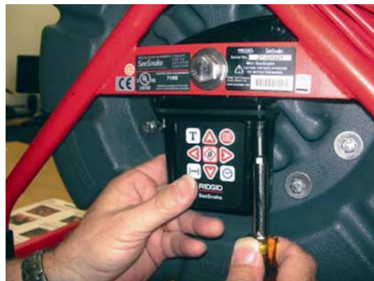
図 17 本機ボックスの取り外し
